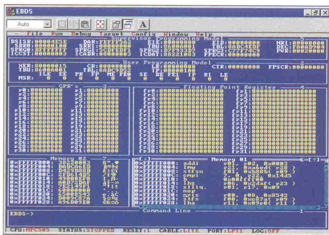
Bild 4. Die 'Enhanced Background Debug Software' gestattet den Durchgriff auf CPU-Register und Speicher des TRAIN-Boards über das BDM-Interface.
