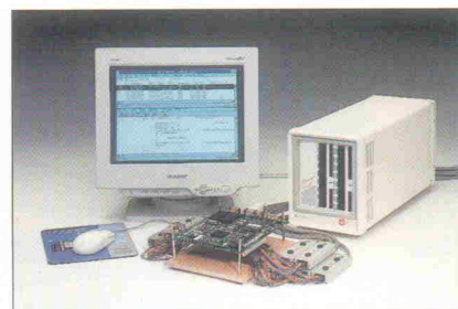
Bild 7. Fehlersuche direkt an der 505er-Zielhardware ermöglicht der Logikanalysator PL200A von dli.
