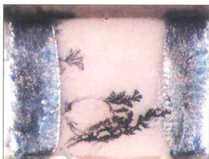
Bild 6. Verbleiben herkömmliche Flußmittel auf der Platine, können sie die Funktion in Frage stellen.
